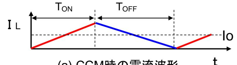
(a) CCM時の電流波形
