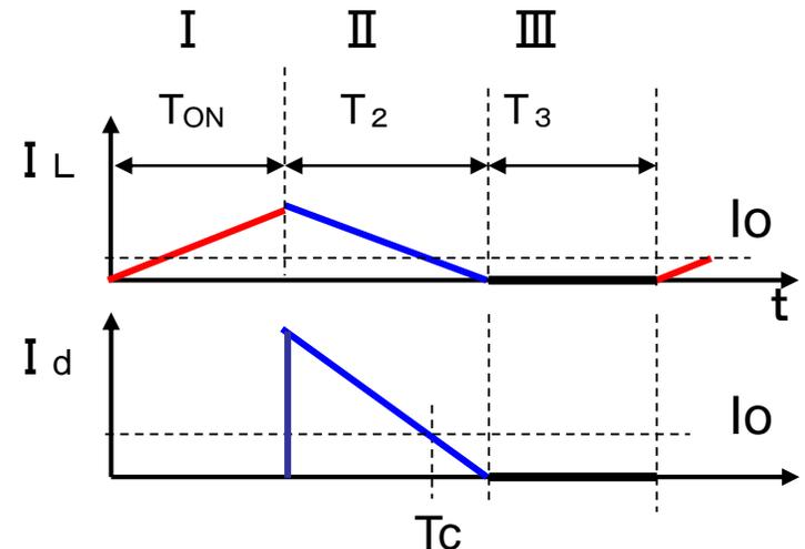
図2.31 DCMの電流波形
