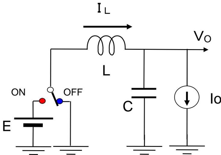
図2.3(a) 降圧形電源の構成図
