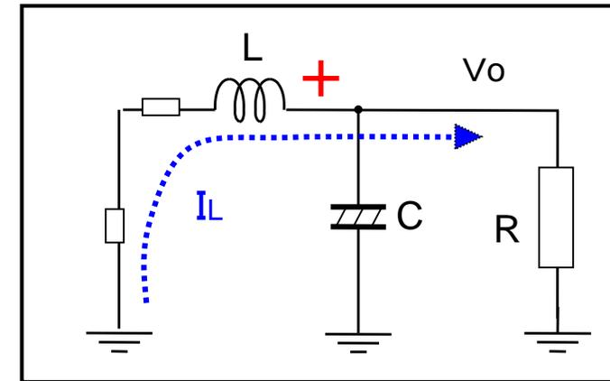
図2.17 降圧形電源の解析図
