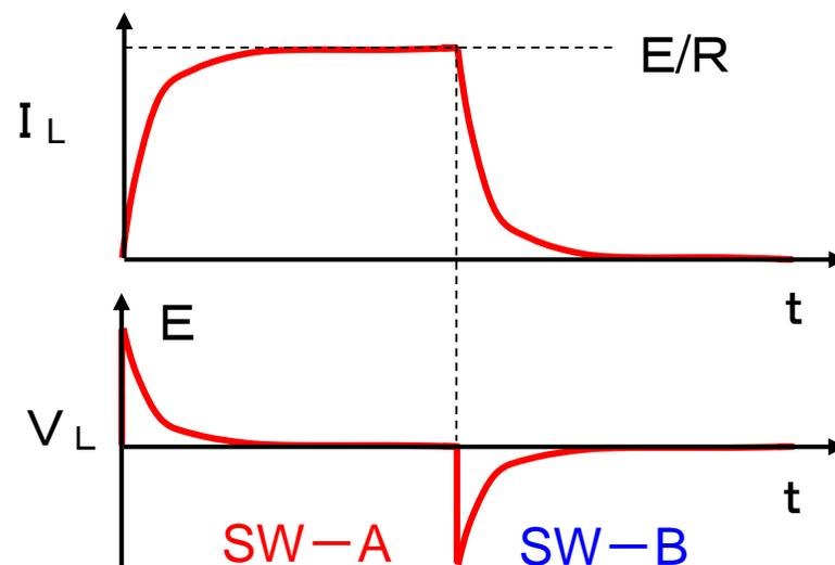
図2.2(b) コイルのスイッチング特性
