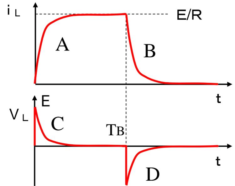
図2.2(b) コイルのスイッチング特性
