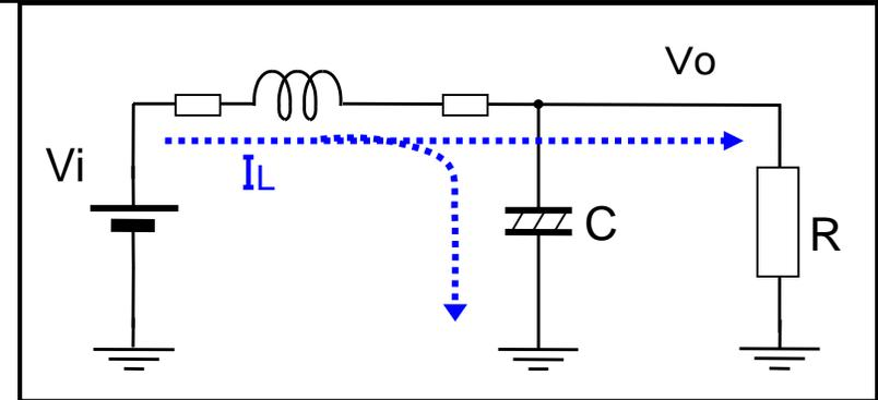
図2.19 昇圧形電源の解析図
