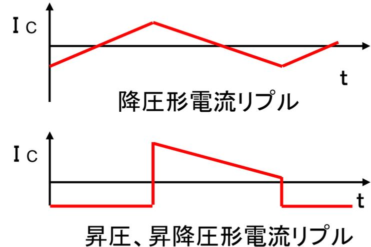
図2.23 コンデンサ電流リップル
