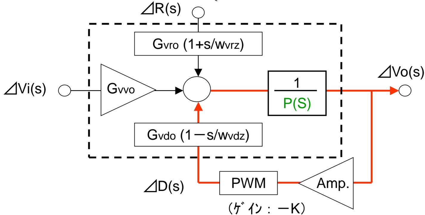
図2.25 スイッチング電源のフィードバック特性図
