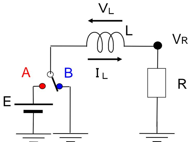
図2.2(a) コイルのスイッチング駆動
