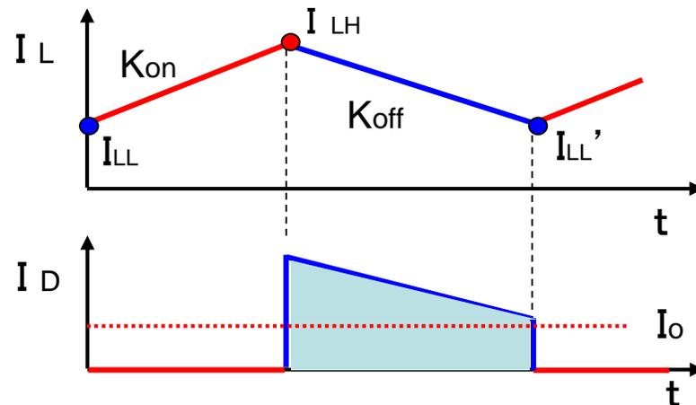
図2.12 昇圧形電源の動作図
