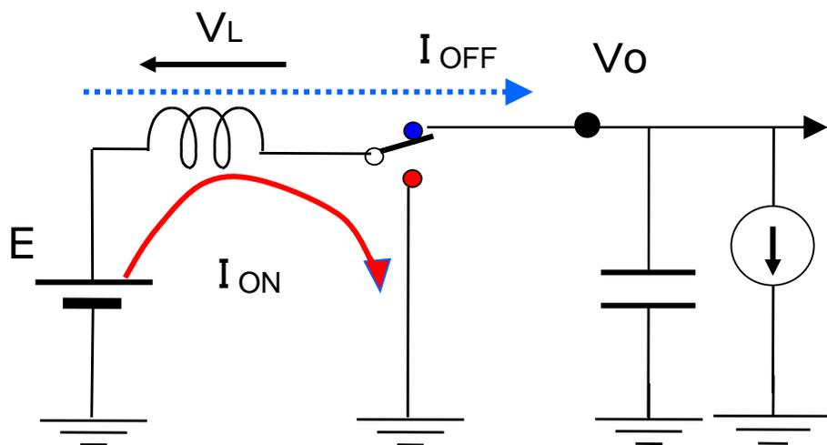
図2.5(a) 昇圧形電源の原理図
