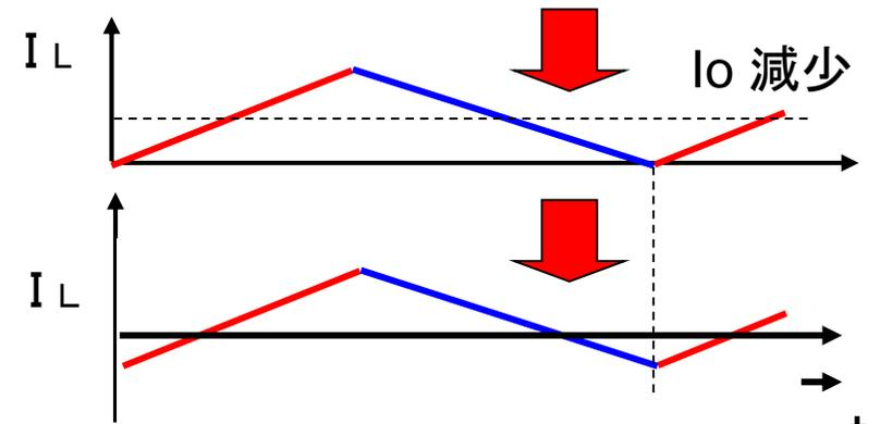
(b) DCM時の電流波形?
