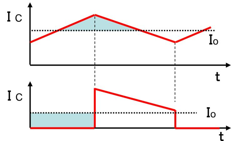
図2.24 コンデンサ電流リップル
