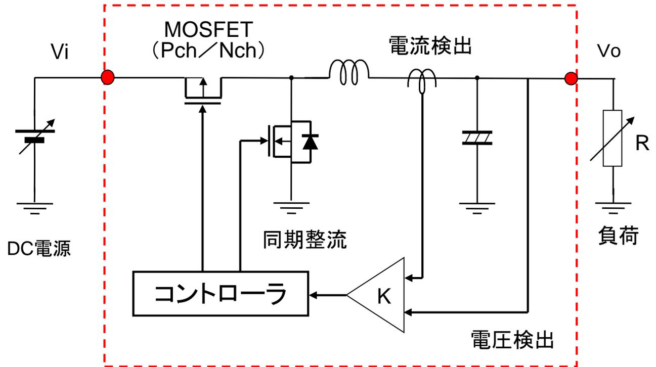
図2.8 降圧形電源の構成例
