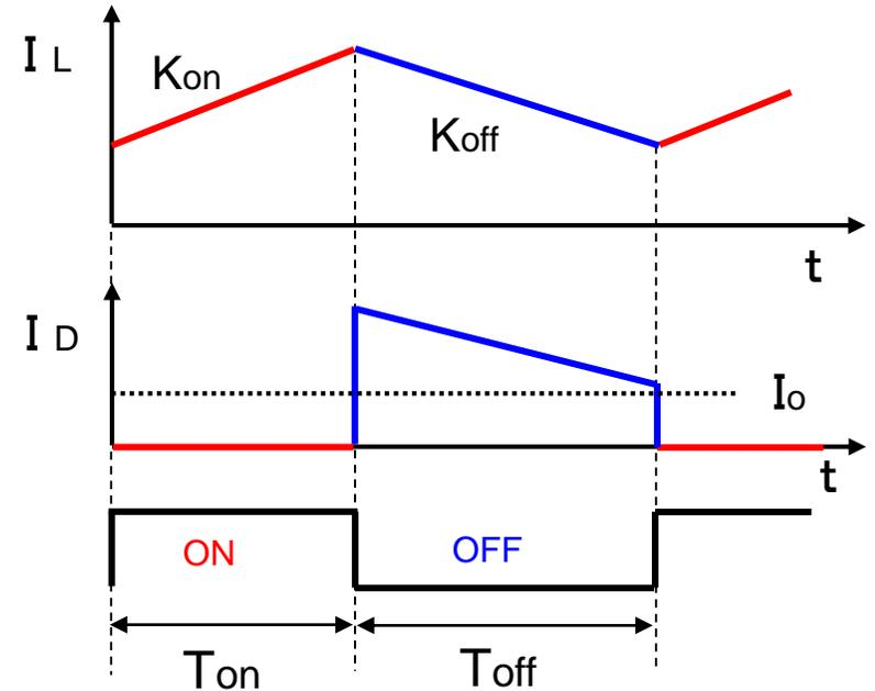
図2.14 昇降圧形電源の動作図
