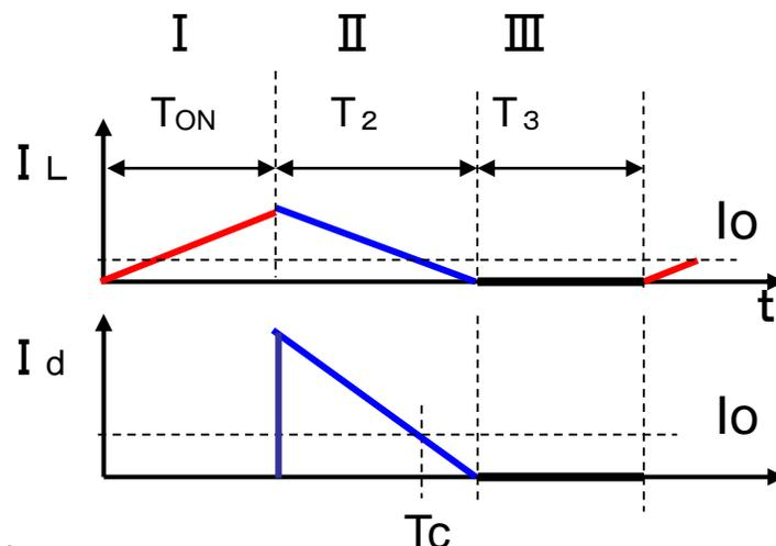
再掲: 図2.31 DCMの電流波形
