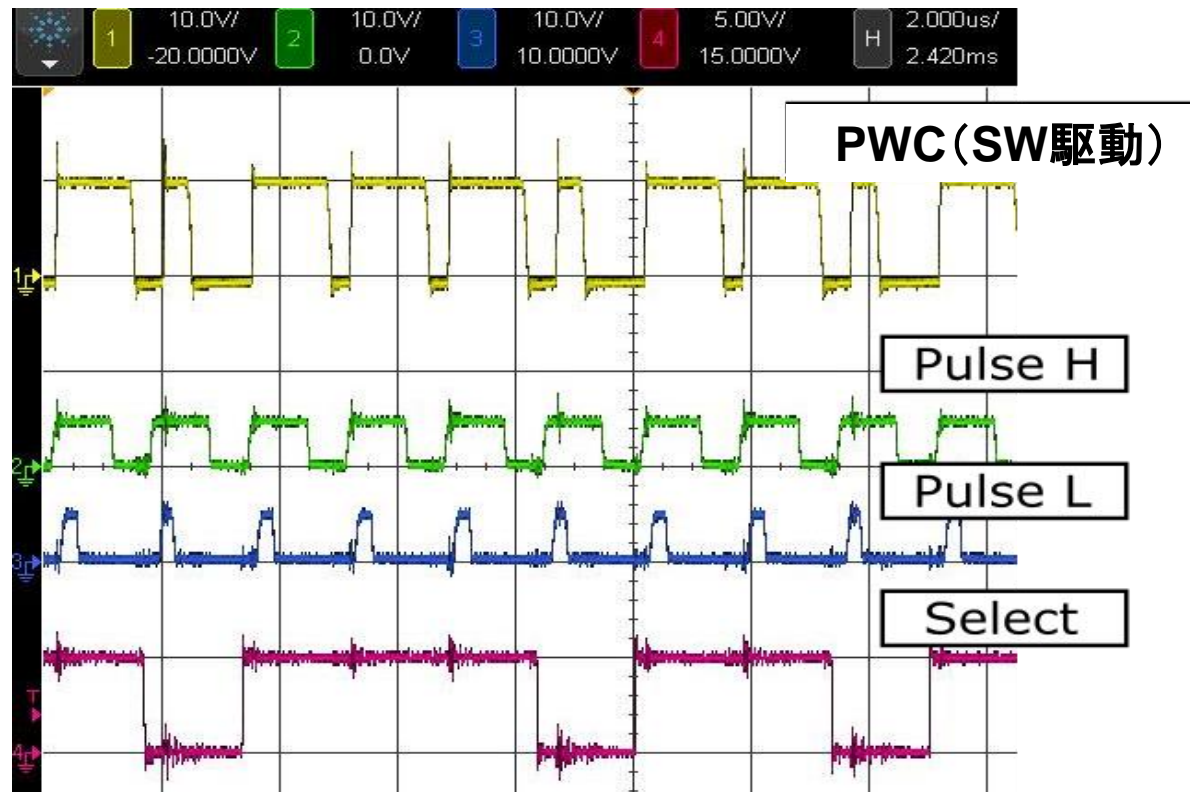
PWC降圧形電源の実測波形
