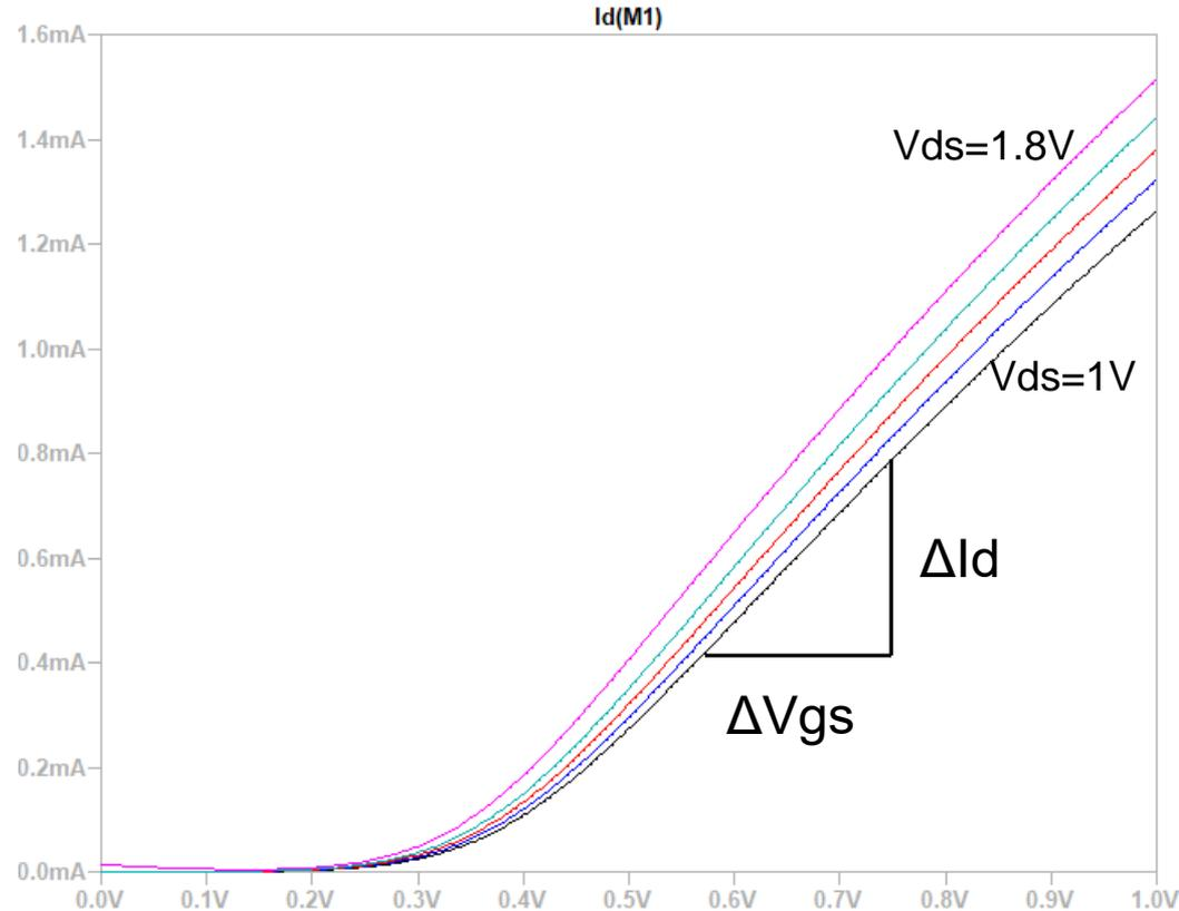
$\frac{\Delta I_d}{\Delta V_{gs}}$  は、別ノードの電流電圧比(コンダクタンス)なので、相互コンダクタンスと呼ばれる。
