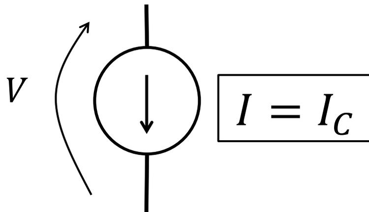
同様に、電流が電圧に関わりなく一定であるブランチが考えられる。これを**電流源**ブランチという。このブランチはどんなに電圧を掛けても流れ込む電流が変わらない特性がある。常用される記号がいくつかあって統一されていないが、上図のものが比較的良く用いられる。
