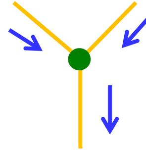
配線で電流が合流する所では、KCLから電流値が加算されて出てゆく。
