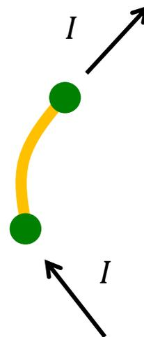
branch両端で、電流という属性が転写される。入って来る電流と出て行く電流は等しい。(電流伝搬の法則)
