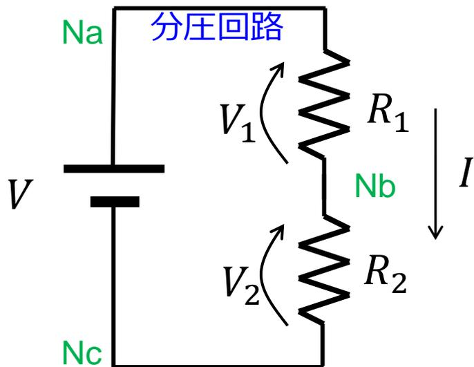
ノードNbのKCLから $R_1$ と $R_2$ に流れる電流は共に $I$ である。Ohmの法則より $V_1 = IR_1, V_2 = IR_2$ である。KVLから、Na-Nc間の電圧 $V$ は、
