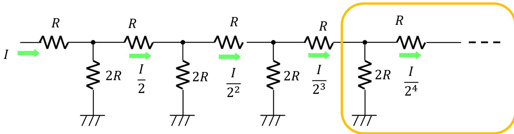
右に無限に伸びる上記ラダーに、左端から電流を注入すると、電流は $1/2$ になって行く。ここで無限ラダーをどこかで打ち切って、代わりに抵抗 $R$ に置き換えても、そのノードの電位は不変である。
