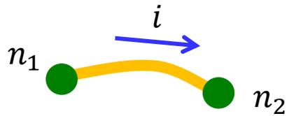
ブランチが0Ω抵抗の場合、電流 $i$ の大きさに関わらずノード $n_1$ と $n_2$ の電位は同じになる。0Ωブランチで接続したノードは全て同電位となり、ひとつのノードであるかのように見なせる(ひとつのノードに縮退する)。電子回路の実配線は、回路論の立場で見ると、実ブランチ(抵抗や電池など)を0Ωブランチでつないだもの(配線したもの)である。
