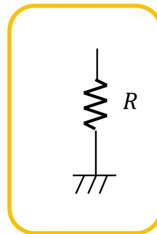
ラダーの残りをZ-Rの**終端抵抗**で置き換える。R-2Rの場合には終端抵抗も $R$ になる。
