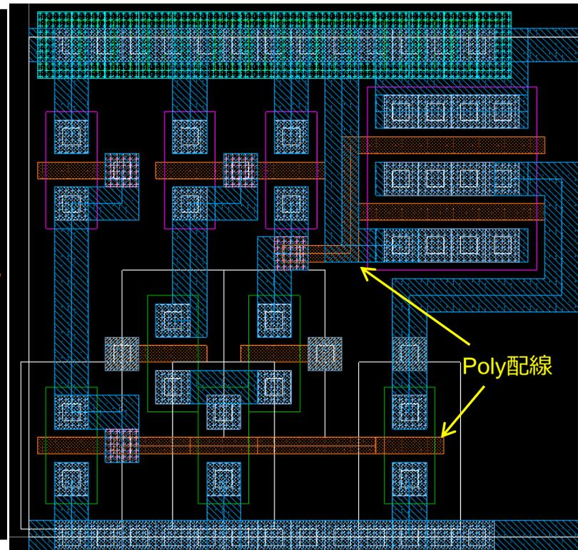
右のレイアウトは、ほぼ左の回路図通りの配置である。ここではメタル配線(水色)を1層で済ますため、Poly配線(橙色で本来はTrのGに用いる)が使われている。しかしPoly配線はメタル配線より、遥かに高抵抗であり、無視できない(かも知れない。) 一般に、IC内ではノードとブランチの区別が曖昧になり、回路図にないブランチを想定(LPE: Layout Parasitic Extraction)しないと、実特性がシミュレーションできない。
