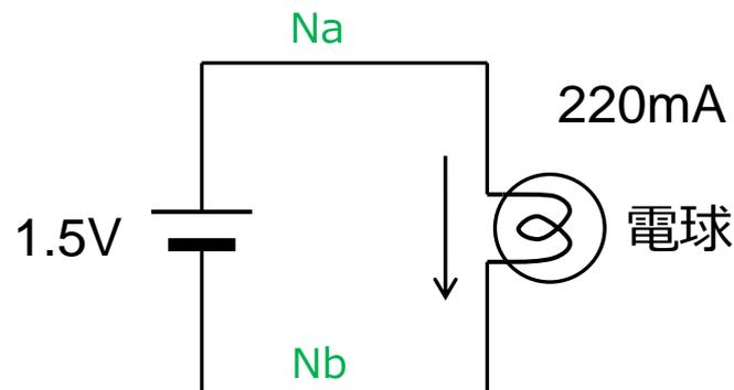
ある豆電球では、1.5Vの電圧を与えた時に220mAの電流が流ることが観測された。この時、豆電球の抵抗 $R$ はOhmの法則を使うと、
