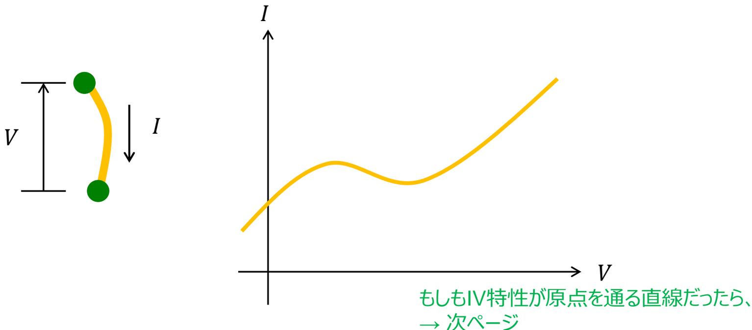
図的に把握するなら、「ブランチ特性はIV平面の曲線(直線も含む)で表現される。」と言える。経験的に、縦軸を電流 $I$ 、横軸を電圧 $V$ とすると考え易い。
