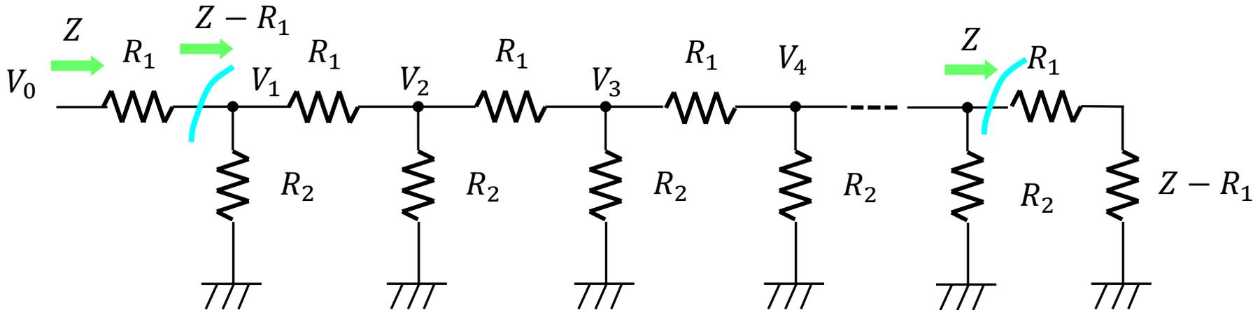
では、各ノードの電位を3dBステップ( $\sqrt{1/2}$ 倍)で減衰させるには、 $R_1$ と $R_2$ をどのような比にすると良いだろうか。それには抵抗分圧の関係から
