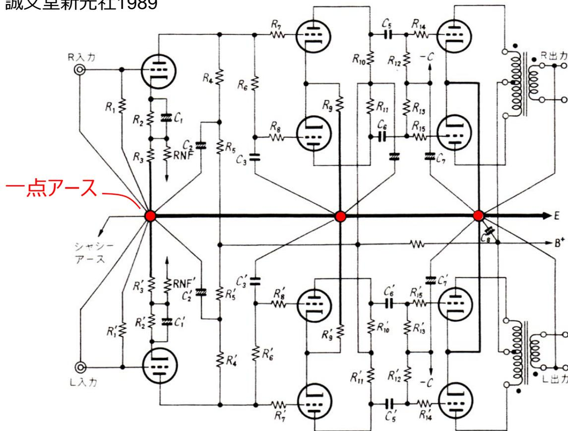
真空管の時代から、オーディオアンプでは1点アースが推奨されていた。当時は部品を立体(3D)接続していたが、その後プリント基板が発明され、多層基板(2.5D配線)によるベタアースが標準的になる。しかしポイントは、1点アースか、ベタアースかという教義争いではない。信号は電位を經由して伝達されるが、回路ブランチは電位差(=電圧)で動作するところにある。すなわち、**信号電位の反対側にあるブランチ電位**(かつてはそれがアースであったが、IC内では電源のことも多い。もちろん他の基準もある)をどう設計すべきか、という問題認識である。
