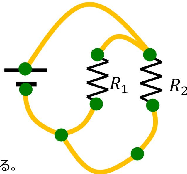
一つの回路図に対し、配線の仕方はいくつもある。実配線は0Ωではないので、配線の仕方に応じておなじ回路図でも特性が変わって来る。
