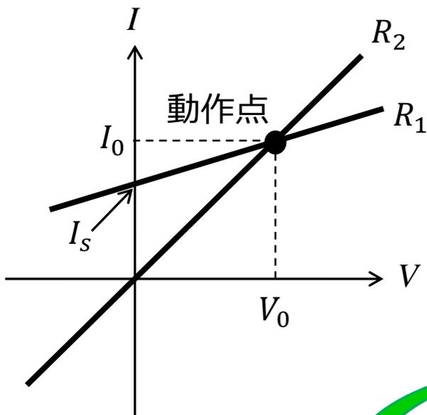
IV特性が原点を通らない場合を考えると、ブランチの電圧と電流が、ある**動作点**で同じであるからと言って、等価なブランチとは限らない。左図のように、動作点からの変化率が異なるかも知れないからである。 $R_1$ の直線は左下の等価回路になるが、動作点からの変化量にだけ着目すると、右下図のように簡単化できる。回路を読むときに多用する手法である。
