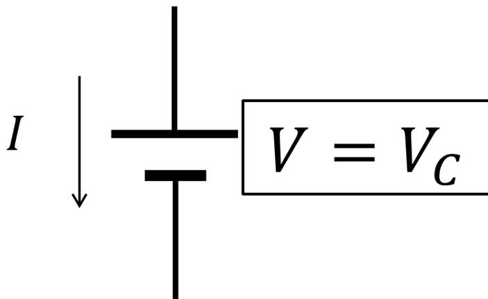
電圧が電流の大きさや向きに関わりなく一定であるブランチを**電圧源**ブランチという。いくら電流を流しても電圧が変わらない点で、電池の理想化である。時間的に変化しない電圧源に対しては、専用記号として上図のものが用いられることが多い。
