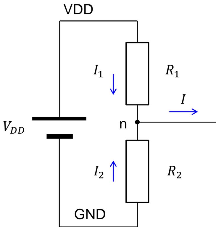
上図の状況では $I_2$ はGNDから $V_{DD}$ の方向に流れる。動作点からの変化分を考えると、電源とGNDはショートされている(同電位)と見做す。
