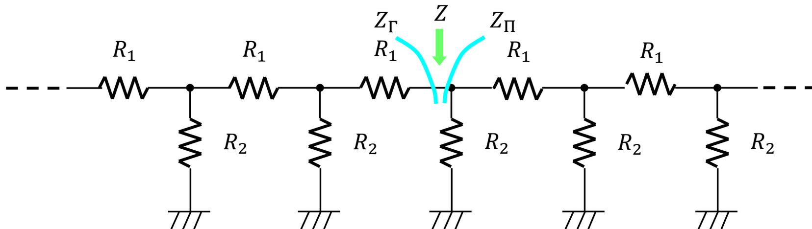
ノードのインピーダンス  $Z$  は、 $Z_{\Pi}$  と  $Z_{\Gamma} = Z_{\Pi} + R_1$  の並列として、簡単に求まる。
