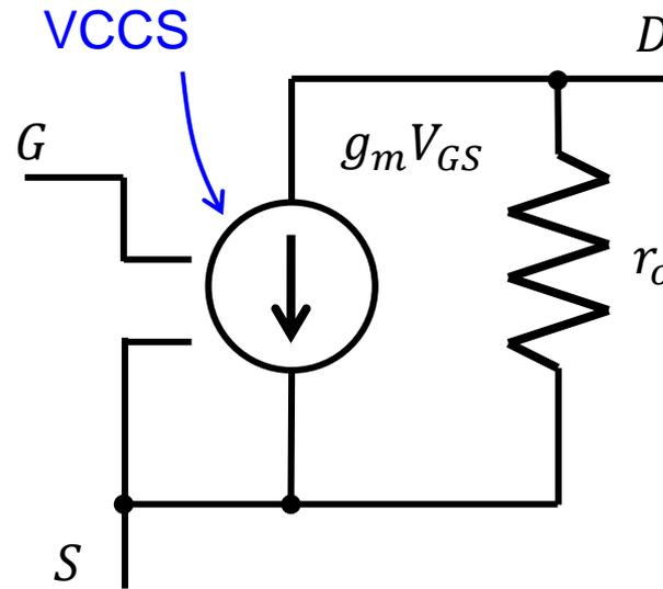
飛び道具ブランチは、必ずしもひとつの素子にまとまっている訳ではない。しかし、能動素子の動作を回路で記述(等価回路で表現)するには、何らかの飛び道具ブランチが必須になる。
