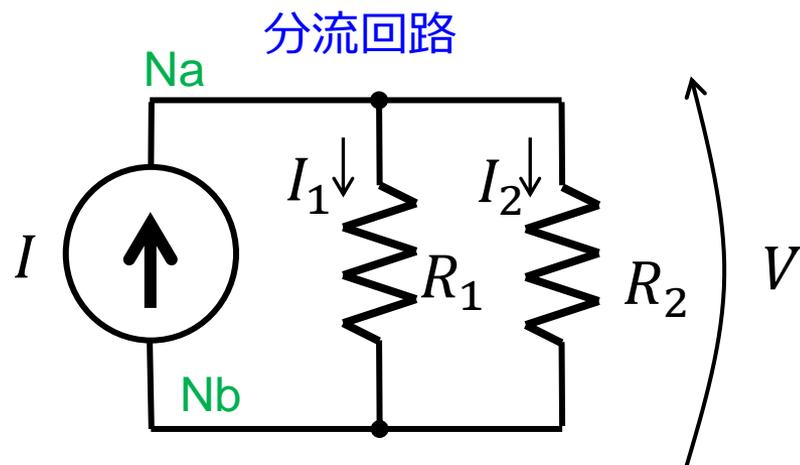
KVLから、 $R_1$ と $R_2$ の両端電圧は共に $V$ である。Ohmの法則より $I_1 = V/R_1, I_2 = V/R_2$ である。NaでのKCLから、
