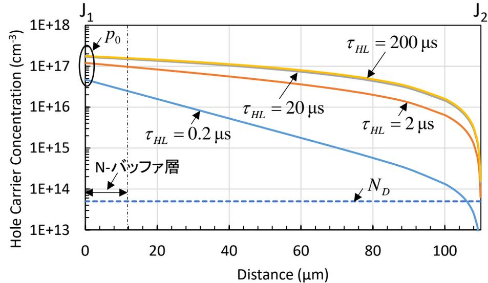
N-バッファ層のドーピング濃度が低い場合 ( $< 5 \times 10^{16} \text{ cm}^{-3}$ )
