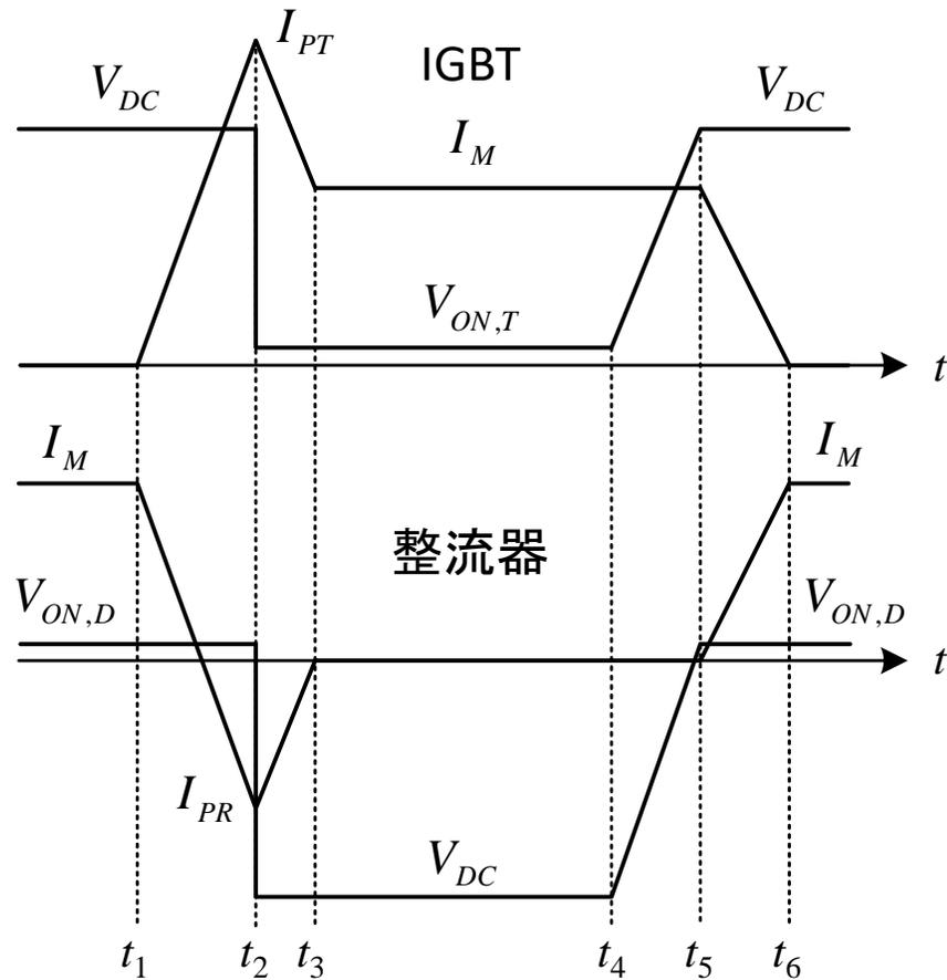
モータ制御回路の中のターンオン・オフ時のIGBTと整流器の電圧電流波形
