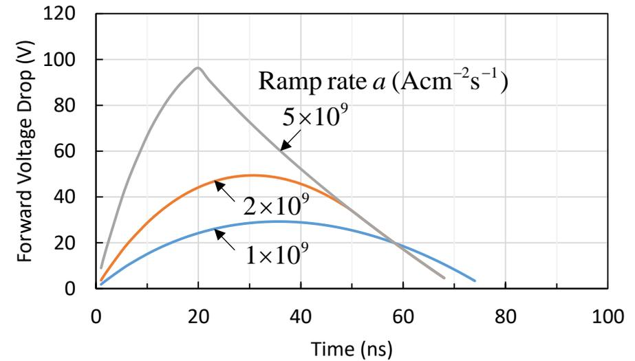
対称型IGBTターンオン(フォワード・リカバリ)時におけるドリフト領域の順方向電圧降下の時間変化
