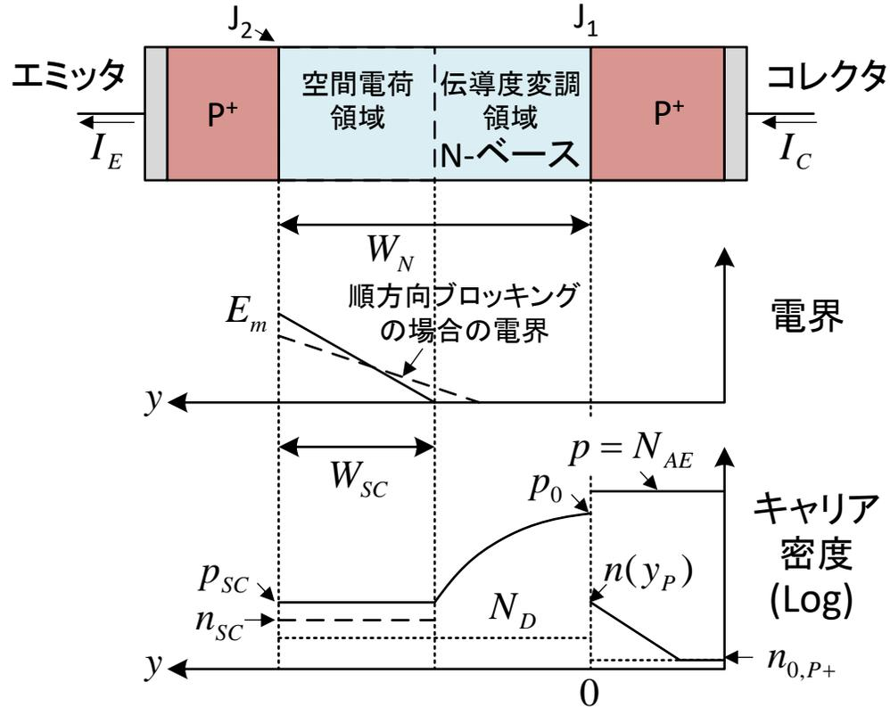
$W_{SC}$  (飽和電流印加時) <  $W_{SC}$  (順方向ブロッキング時)
