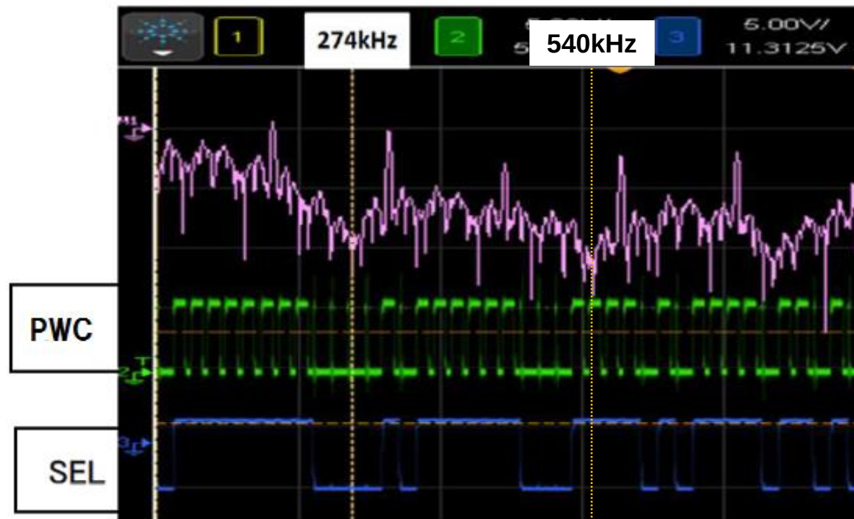
PWC昇圧形電源のスペクトラム1
