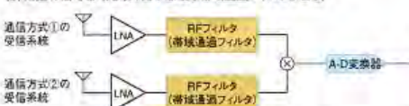
図A-2 アンダーサンプリング方式で2つの通信方式を同時受信 KDDIは、アンダーサンプリング方式によるダイレクトサンプリングにおいて、標本化周波数をどの程度まで低く抑え込めるのかについてシミュレーションで評価した。特に、2つの通信方式の無線信号を同時に受信する事例を想定している。アンダーサンプリング方式とは、ナイキスト周波数以下の速度で標本化したときに、ベースバンド帯域に生じる折り返し成分を利用してデジタル信号に変換する手法である。2つの通信方式を同時受信するケースには、折り返し成分が重ならないよう標本化周波数を選択することが必要になる(a)。加えて、A-D変換器の前段に急峻な帯域通過(バンドパス)フィルタを用意する必要がある。所望チャンネルの信号の近傍に不要な信号成分が存在すると、この折り返し成分もベースバンド帯域に流れ、雑音となるからである。(図:KDDI研究所の資料を基に本誌が作成)
