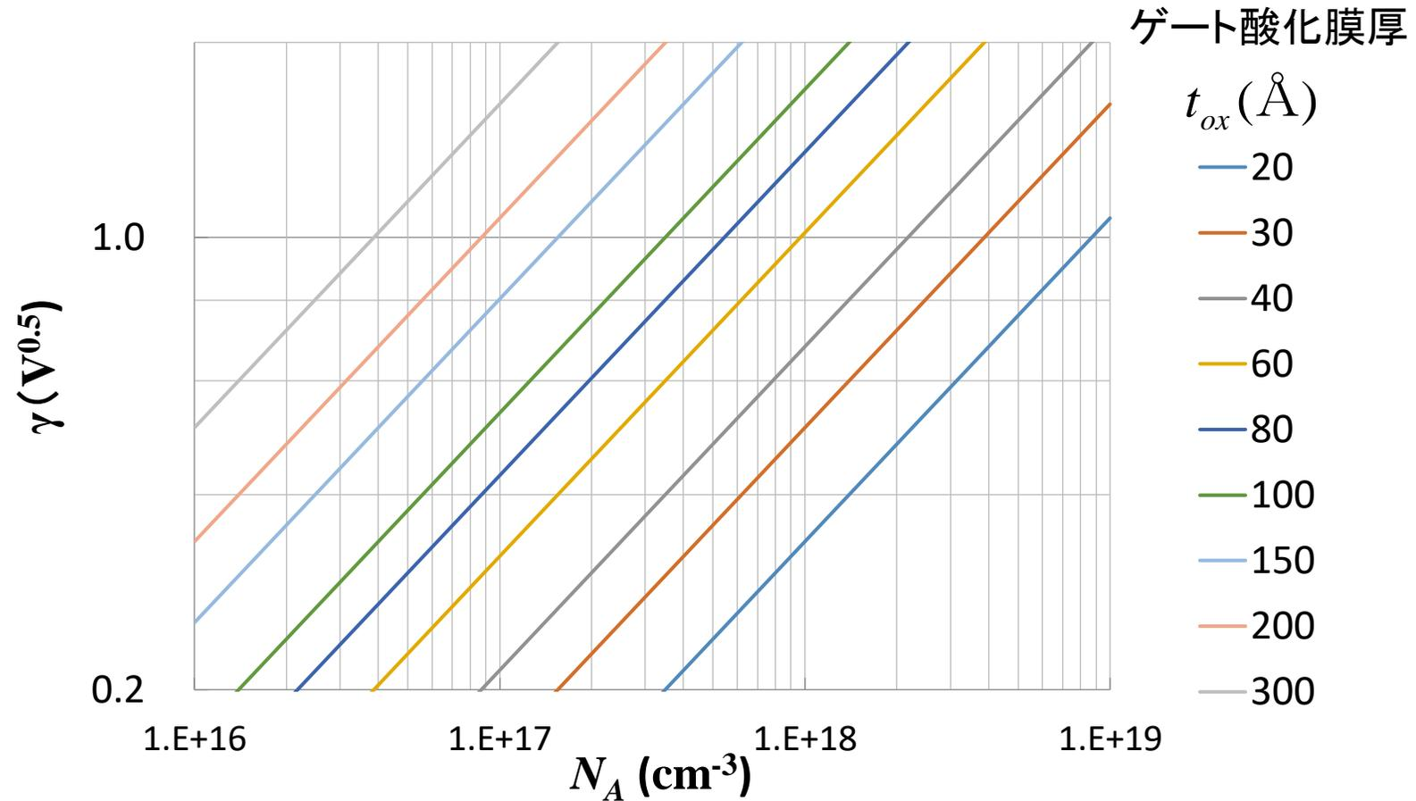
基板バイアス係数  $\gamma$  と基板不純物ドーピング濃度  $N_A$  の関係
