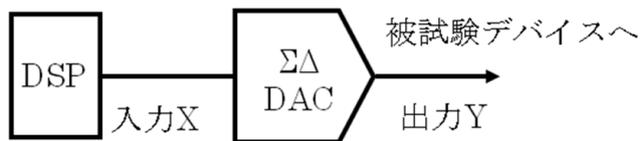
図2 従来のデルタシグマ DAC を用いた信号発生回路
