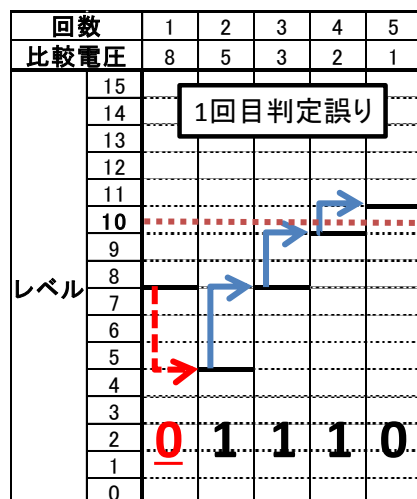
図 4. 4-bit 5-step 加算型 SAR ADC 動作例 (誤判定有) .
