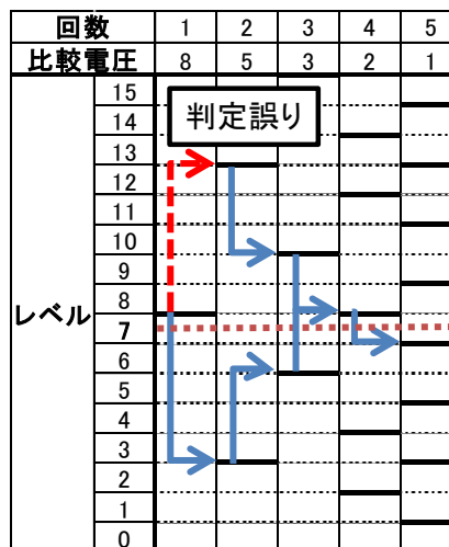
図 5. 4bit5step 加減算型 SAR ADC 動作例 (誤判定含) .
