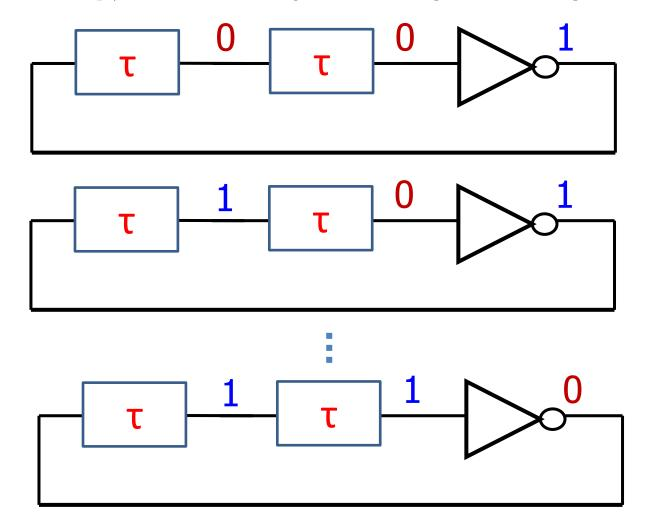
考察 TDCでは取り扱う入力信号が時間信号なので リング発振回路構成により剰余が容易に得られる。 電圧信号を入力とするADCでは剰余を得るのは簡単ではない。11
