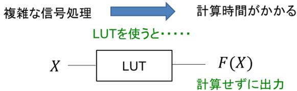
図 2 : ルックアップテーブル(LUT)回路
