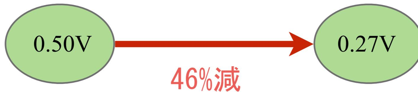
擬似アナログ信号の適用でスペクトルの大幅な減少を確認
