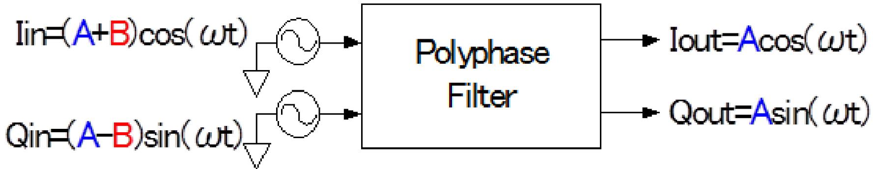
$$\underbrace{Ae^{j\omega t}}_{\text{信号成分}} + \underbrace{Be^{-j\omega t}}_{\text{イメージ成分}} \longrightarrow \underbrace{Ae^{j\omega t}}_{\text{信号成分}}$$
