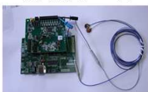
プロトタイプ伝送系装置部分(EEGセンサプローブ装着)
