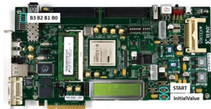
図 6 6-bit Gray code 時間デジタルタイザ回路 FPGA 実現
