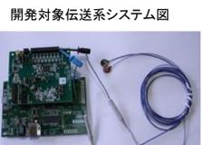
プロトタイプ伝送系装置部分(EEGセンサプローブ装着)
