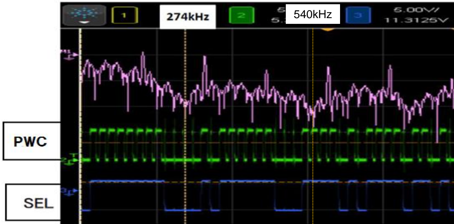
図10: 実機でのPWC制御波形とそのスペクトラム
