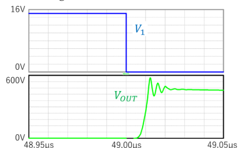
図 2 ターンオフ時の電圧 V_{OUT} のオーバーシュート Fig2. Output voltage overshoot during turn-off for the circuit shown in Fig. 1.
