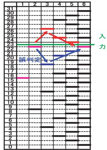
図 5 5 ビット 6 段逐次比較近似 ADC アルゴリズム (ケース 2) の動作例.
