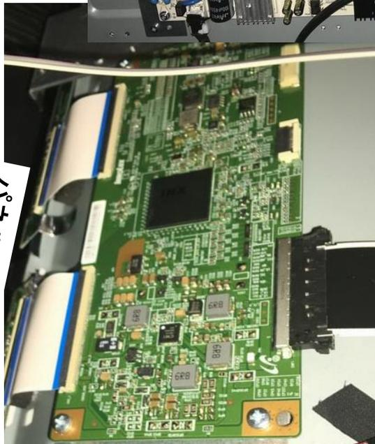
LCDパネル制御基板(パネルメーカーが提供)
