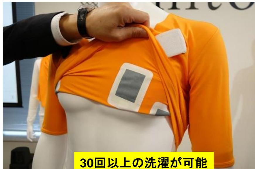
厚さ $12.5\mu\text{m}$ の高分子フィルム上にセンサや集積回路(有機トランジスタや有機ダイオードなどの有機デバイス)を作製。電力はワイヤレス給電にて供給。無線タグで広く使われている周波数 $13.56\text{MHz}$ 帯において、 $10\text{V}$ の低駆動電圧で $20\text{mA}$ の大電流を流すことができる。
